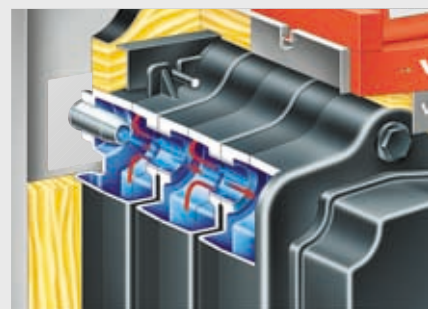
Il sistema JetFlow impedisce la formazione di condensa e criccate
